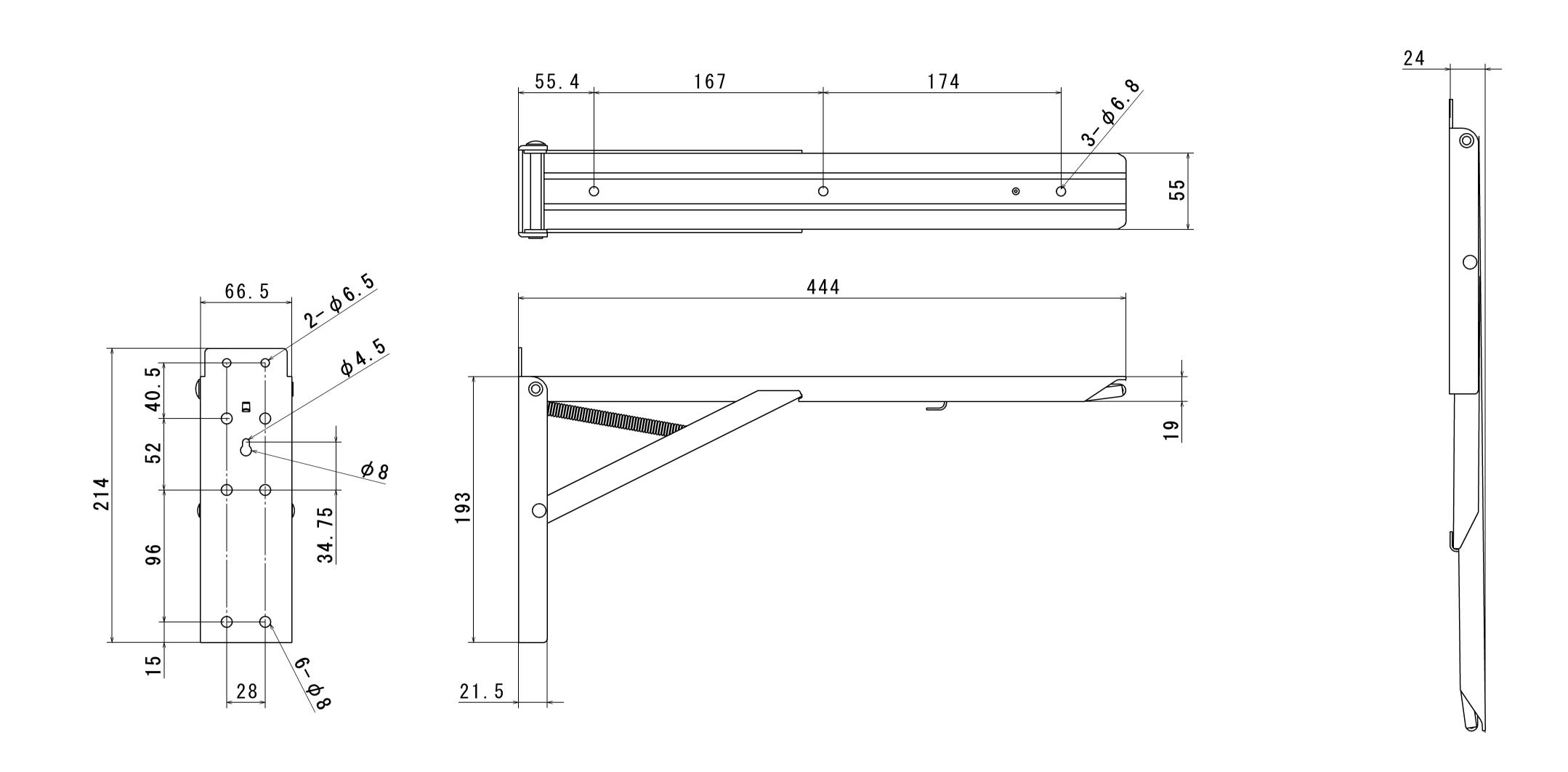
折りたたみ式 棚受金具 ジャンボ60 寸法図 【S=1/2】
